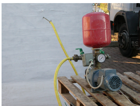
Fig. 2 - L'originale attrezzatura messa a punto per l'inoculo della miscela di semina.
